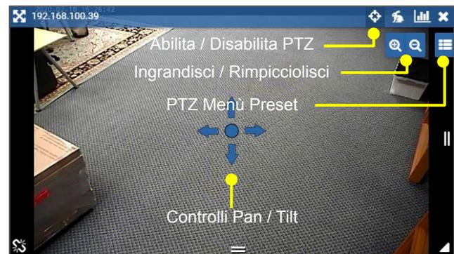
**Per controllare il PTZ:** prima di tutto, abilita il controllo PTZ, cliccando sull'icona *PTZ*. Successivamente, usa i controlli Pan/Tilt e Zoom che compariranno sullo schermo (il controllo è disponibile utilizzando un mouse, joystick o input tattili). Utilizza il *Menù dei Preset* per passare tra le diverse viste predefinite della telecamera.
